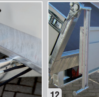
5-stufiger, sehr starker Zylinder, Kippwinkel 48° (bis 6100 kg)
