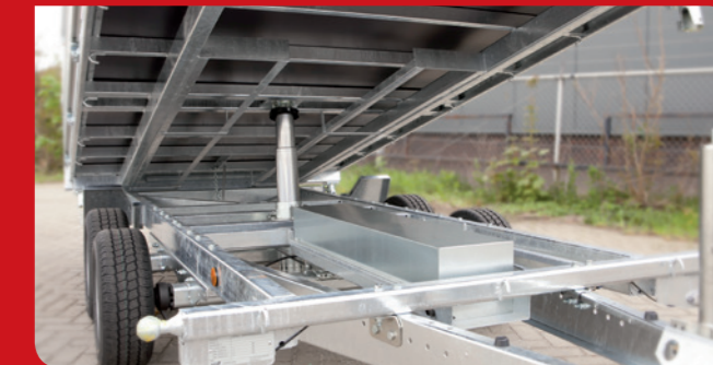
Pomp en accu afgedekt in het chassis
